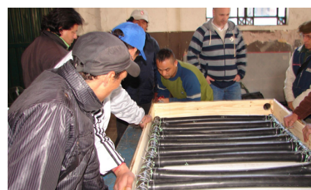
Fig. 1: Armado de parrilla de caños y caja aislante.
